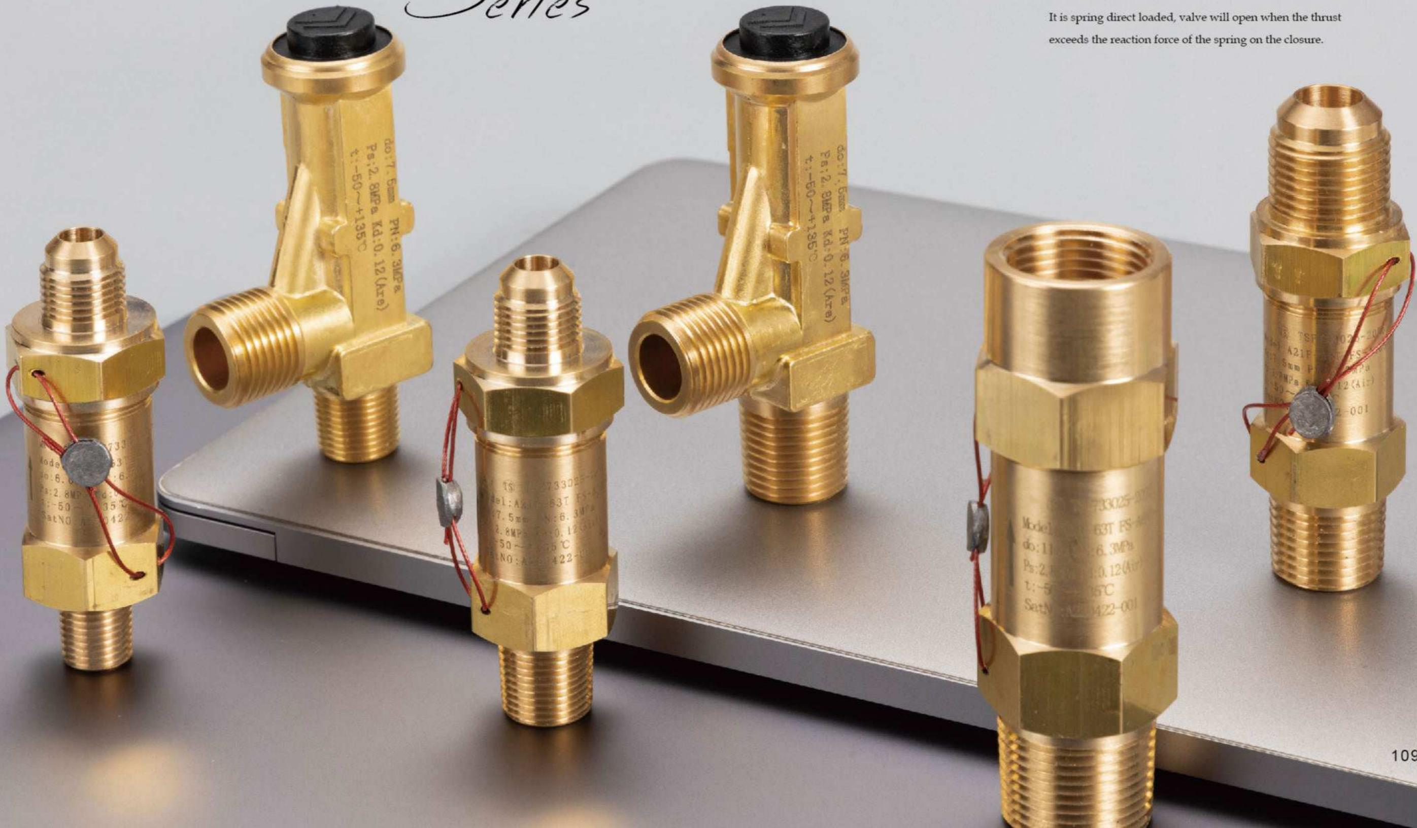
弹簧直接载荷式安全阀,当在设定条件下,推力超过作用在关闭件上的弹簧的反作用力时,通过撞击在关闭件上的欠压流体打开泄压。
